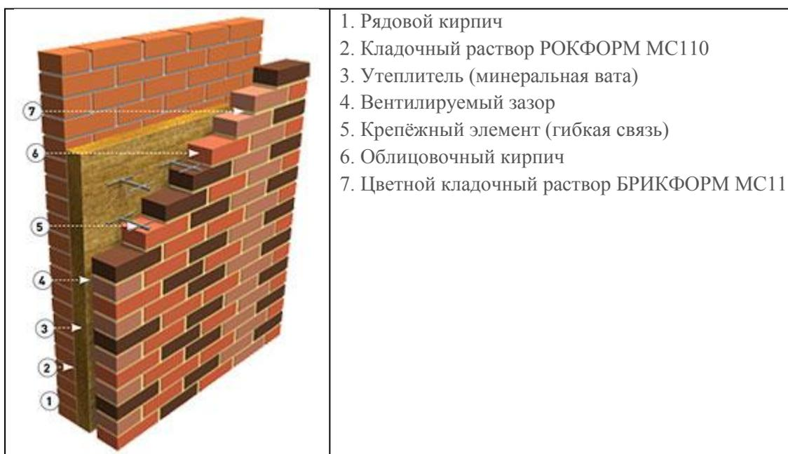
Рис. 10. Система с рядовым кирпичем, утеплителем, финиш облицовочный кирпич
